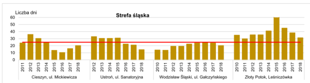
Rysunek 5 Liczba dni w latach 2010-2018 w strefie śląskiej, w których najwyższa ośmiogodzinna średnia krocząca stężenie ozonu przekraczała 120 \mu\text{g}/\text{m}^3
